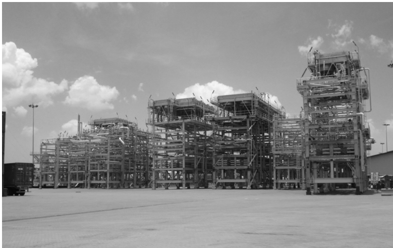
Fig. 1. Esempio di impianto modulare preassemblato
